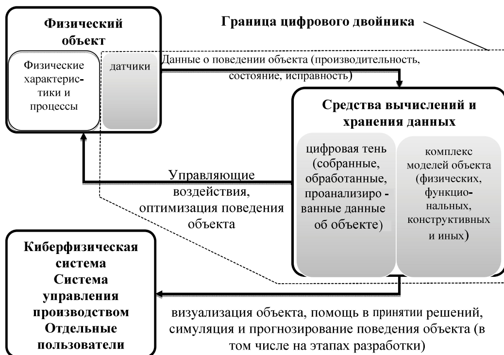
Структура цифрового двойника / The structure of the digital twin
